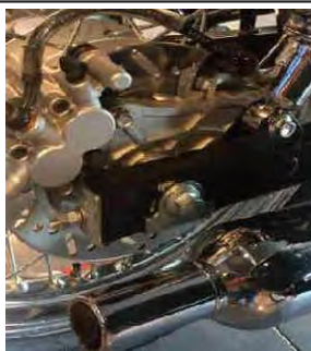
Dévisser l'écrou de l'axe de la roue arrière
