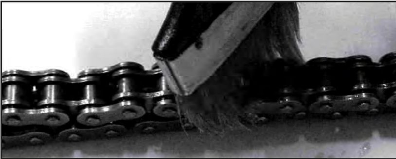
Nettoyer et appliquer de la graisse à chaîne spéciale joints toriques
